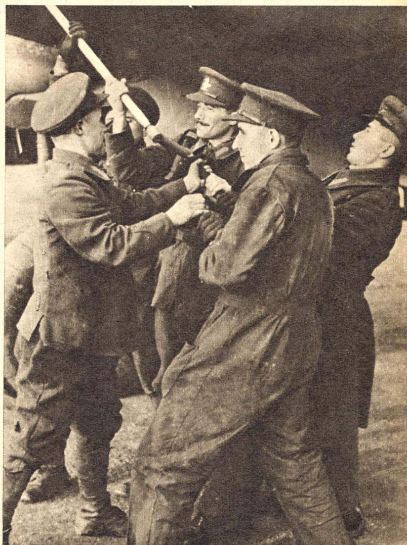
Männer vom Bodenpersonal der rumänischen Fliegertruppe beim Anwerfen eines Motors mit der Handkurbel
